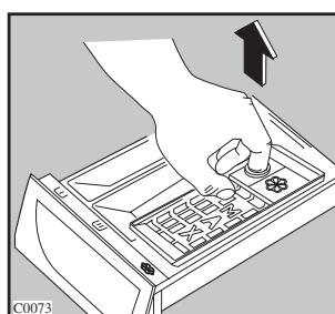
Стиральный порошок может также скапливаться в отсеке, в котором устанавливается дозатор: прочищайте его с помощью старой зубной щетки. После чистки установите дозатор на место.
